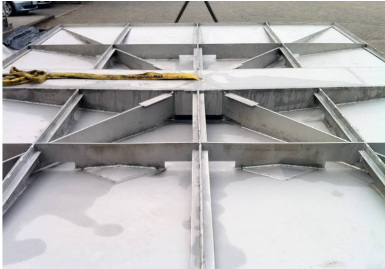
Die Dachelemente in der Werkstatt, Foto: Syra_Schoyerer Architekten
